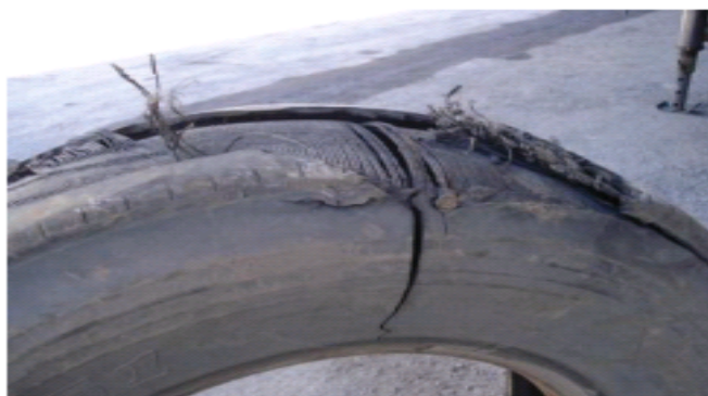
Figura 05: Exemplo de uma sucata por acidente na banda de rodagem.
