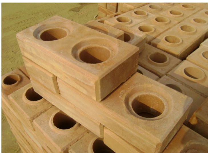
Figura 04: Tijolo modular de solo cimento.
