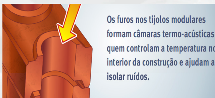
Figura 05: Câmaras termo-acústicas.
