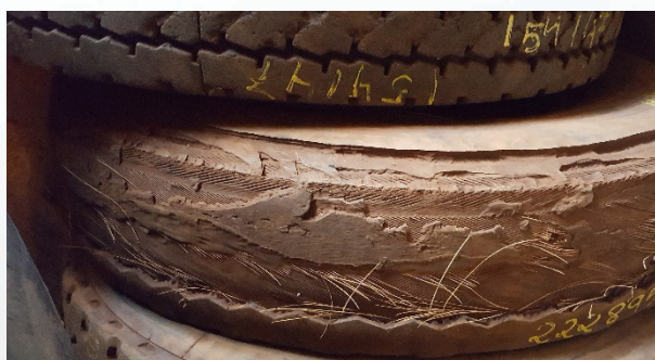
Figura 08: Acidente na banda de rodagem
