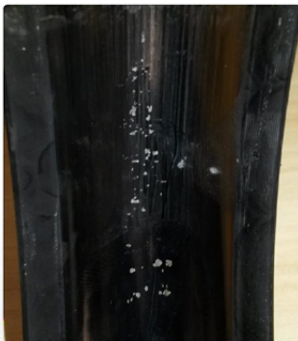
Figura 4 – Detalhes da pista externa do rolamento. Fonte: Arquivo pessoal da empresa (2016).
