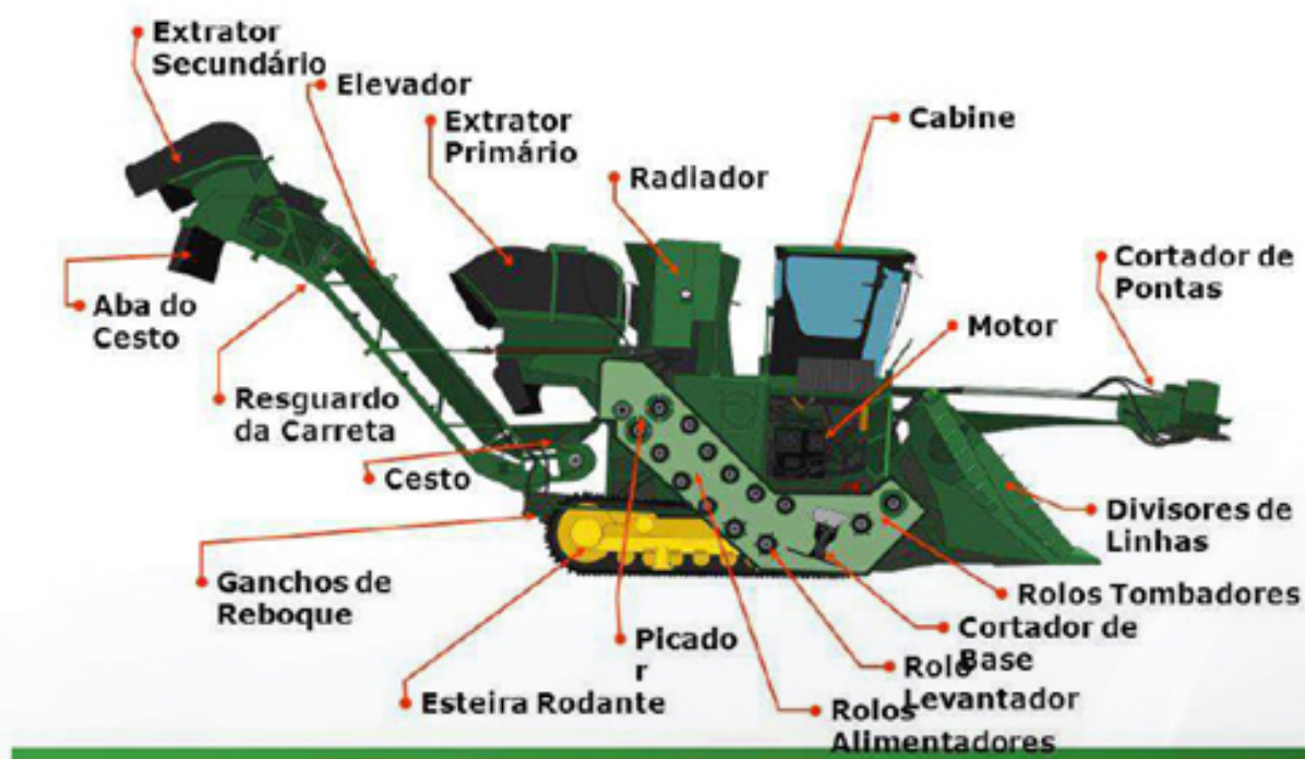
Figura 1 – Componentes da Colhedora de Cana.
